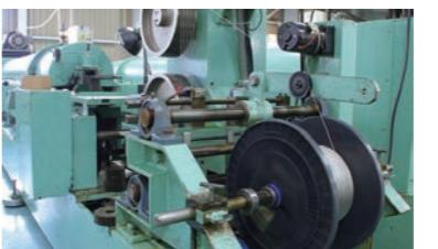
伸線機で製造したステンレスワイヤを燃り合わせてワイヤロープにします。様々な燃り構成にご対応可能です。
