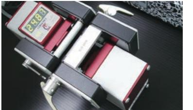
ワイヤロープの線径(直径)を非接触で簡単に、正確、スピーディに測定する装置です。ワイヤロープの微小さな傷や歪みが、数値(平均・最大・最小値)となって表れます。
