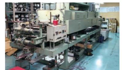
熱硬化型塗料を高温で焼き付けることで、ワイヤロープに塗装を施します。
