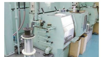
入荷した母材をダイヤモンドダイスを使って、段階的に細くします。
