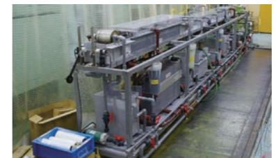
ワイヤを電解液中で電解し、表面を平滑化させます。この処理を加えることでワイヤ表面の微細な鋸を防ぎます。また、同時に超音波洗浄を行うことで、ワイヤについた油などの汚れを落とすことが出来ます。
