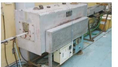
直線性と不反発性を高める為、還元ガスによる熱処理を加えます。
