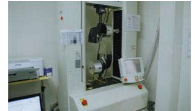
ワイヤロープや、その材料となるワイヤ、末端加工された製品の引張強度を測定します。精緻な波形と数値で表示される最大荷重(破断荷重)や伸び率(裂断長・伸び・平均値)を分析することで、高性能な製品の管理、研究開発が可能です。
