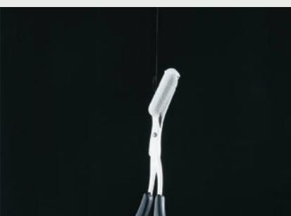
当社が開発した、シングル伸線で直径9 $\mu$ (0.009mm)の世界最小レベルのステンレスワイヤ。9 $\mu$ を49本撚り合わせた0.08mmのステンレスロープの製造も可能です。医療機器など様々な分野での活躍が期待されています。
